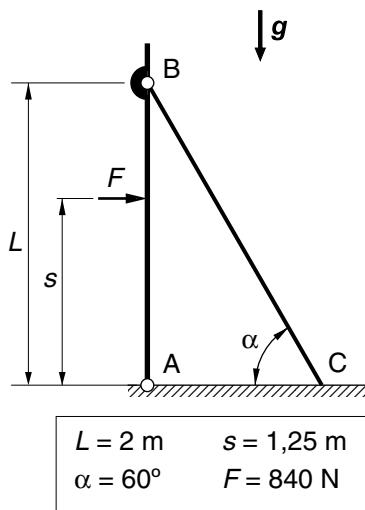
La pantalla paravent de la figura està articulada amb el terra pel punt A i es manté vertical mitjançant la barra articulada en el punt B que recolza a terra en el punt C, on no llisca. L'acció del vent equival a una força resultant  $F = 840 \text{ N}$  aplicada al centre de la pantalla. Les masses de la pantalla i de la barra es consideren negligibles.
