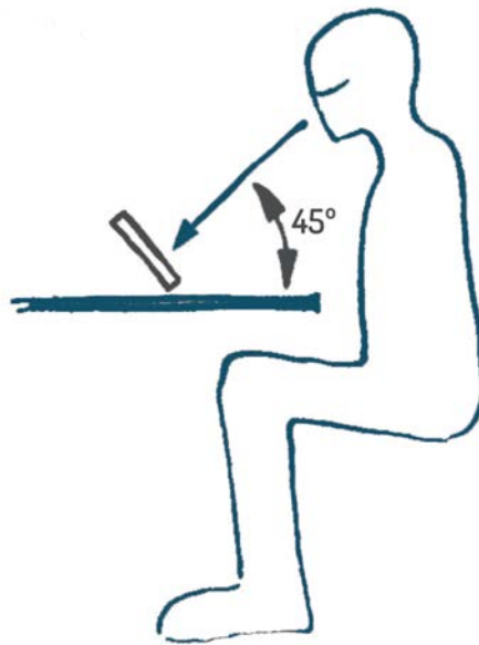
IMATGE G. Esquema de la inclinació òptima de la mirada d'un usuari mitjà a un smartphone col·locat sobre una taula
