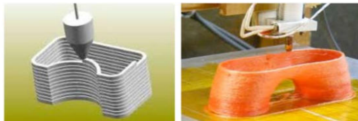
IMATGE D. Seqüència d'impressió de capes fines de material fins que es completa l'objecte en 3D
